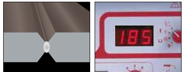
Passe de pénétration MIG Short-Arc épaisseur < 25 mm.
