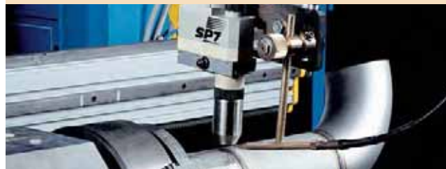
Bild 8: Rundnaht an rostfreiem Stahlrohr im PAW-Verfahren mit Zusatzwerkstoff zum Ausgleich von Abweichungen in der Materialstärke und Verzug (1GR Position)
