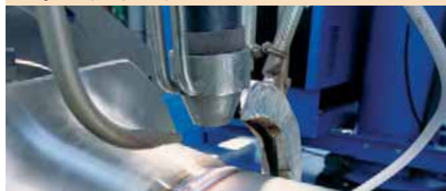
Bild 9: Rundnaht an rostfreier Rohr-/Flanschverbindung mit Schutzgas (1GR Position)
