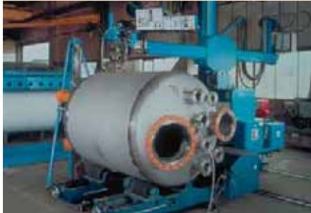
Bild 3: Plasmaschweißen von Rundhärten in Wannenlage zur Herstellung von Druckbehältern für die chem. Industrie: Austenitischer, rostfreier Stahl 7 mm
