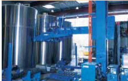
Bild 4: Plasmaschweißen in Querposition zur Herstellung von Lagerbehältern für die Nahrungsmittelindustrie: Austenitischer, rostfreier Stahl 3 mm
