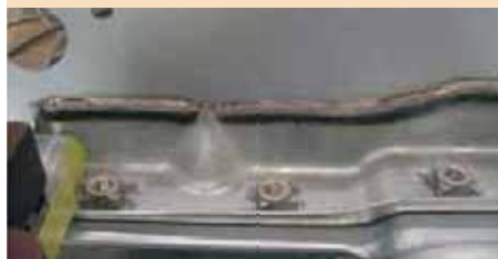
Bild 11: Plasmalöten an galvanisierten Blechen Oerlikon COPPERFIL CuSi 3
